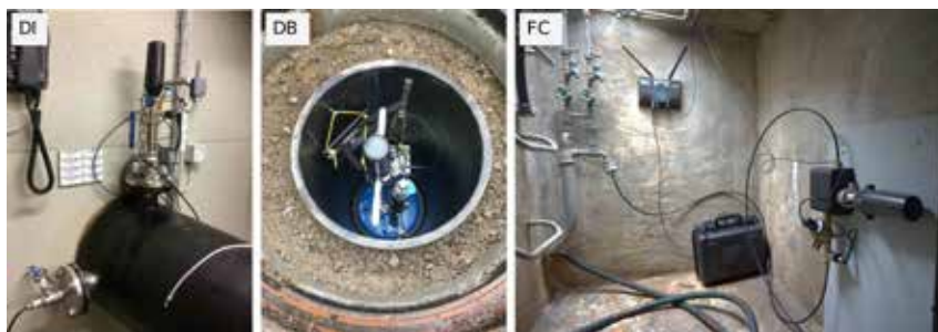
Bild 2: Fotos der drei installierten Sensortypen zur Messung der Wasserqualität. Direct Insertion (DI) zur Installation in begehbaren Schächten, Direct Bayonet (DB) zur direkten Installation in der Trinkwasserleitung in Minischächten im Strassenraum und Flow Cell (FC) zur Bypass-Messung in Anschlussschächten von Trinkwasserbrunnen.
