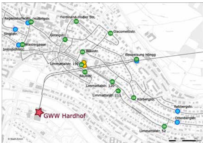
Bild 1: Übersichtskarte der Sensorstandorte im Pilotgebiet Höngg. Der rote Stern zeigt das Grundwasserwerk Hardhof. Die grünen Punkte verweisen auf Messstellen für Qualitätsmessungen, die blauen Punkte auf Messstellen für Hydraulikmessungen und die gelben Punkte auf die zwei Bodentemperaturmessungen. Die Abkürzungen in den grünen Punkten bezeichnen den Sensortyp der Qualitätsmessungen. Der Hauptzufluss in das Pilotgebiet ist „Einspeisung Höngg“ über die grosse Versorgungsleitung vom Pumpwerk am Hardhof kommend.
